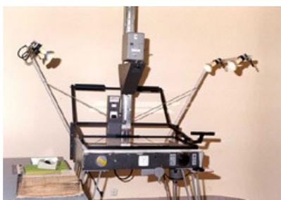
Le document à filmer posé sur la table auxiliaire sera placé sur la table après ouverture du presse livre au moyen de la poignée noire située à droite. Il est possible de mettre sous les gros registres un berceau qui compense l'épaisseur du registre et permet de ne pas l'abîmer sous la glace qui donne de la planéité au document à filmer et assure la netteté de l'image.
