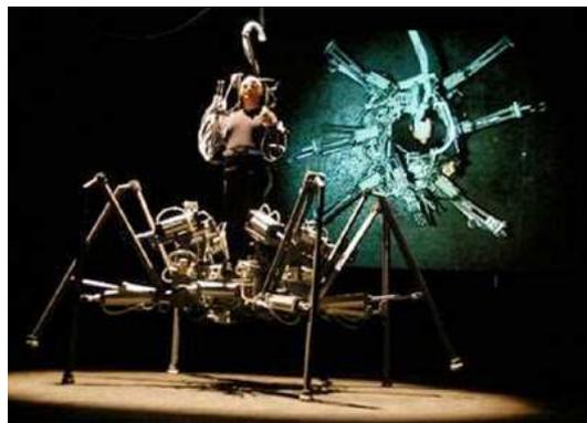
*Walking Head* (2006) est un robot interactif de six jambes et de 2 mètres de diamètre doté de capteurs ultra-sons pouvant détecter la présence de personnes lui faisant face. Le robot exécute alors une chorégraphie pendant plusieurs minutes. Ici, le corps de l'artiste a complètement disparu.
